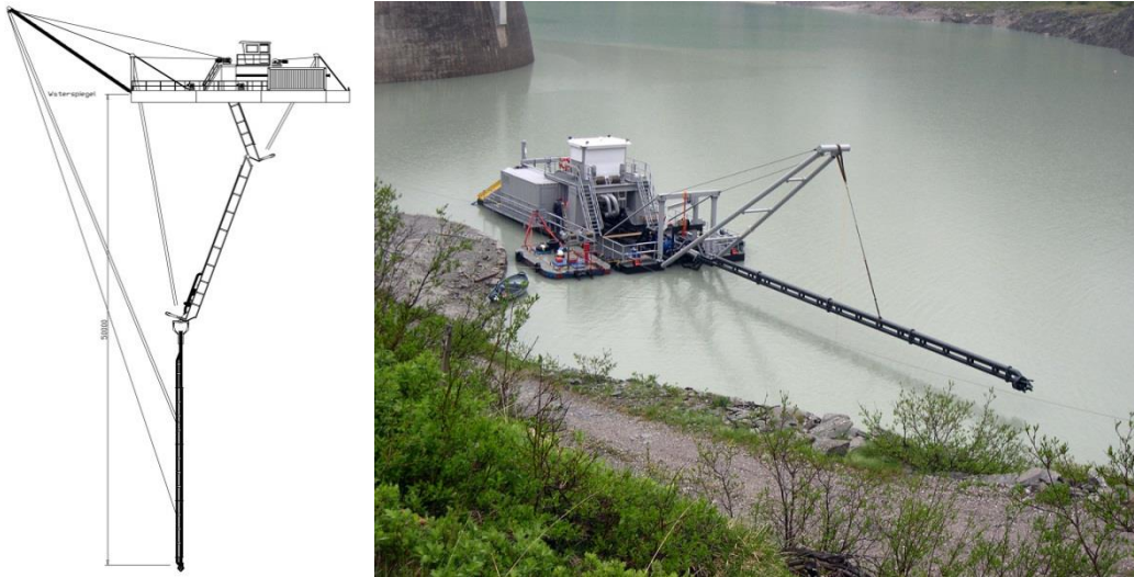
Figure 38 - Exemple de drague aspiratrice à élinde modulable (VIS)
